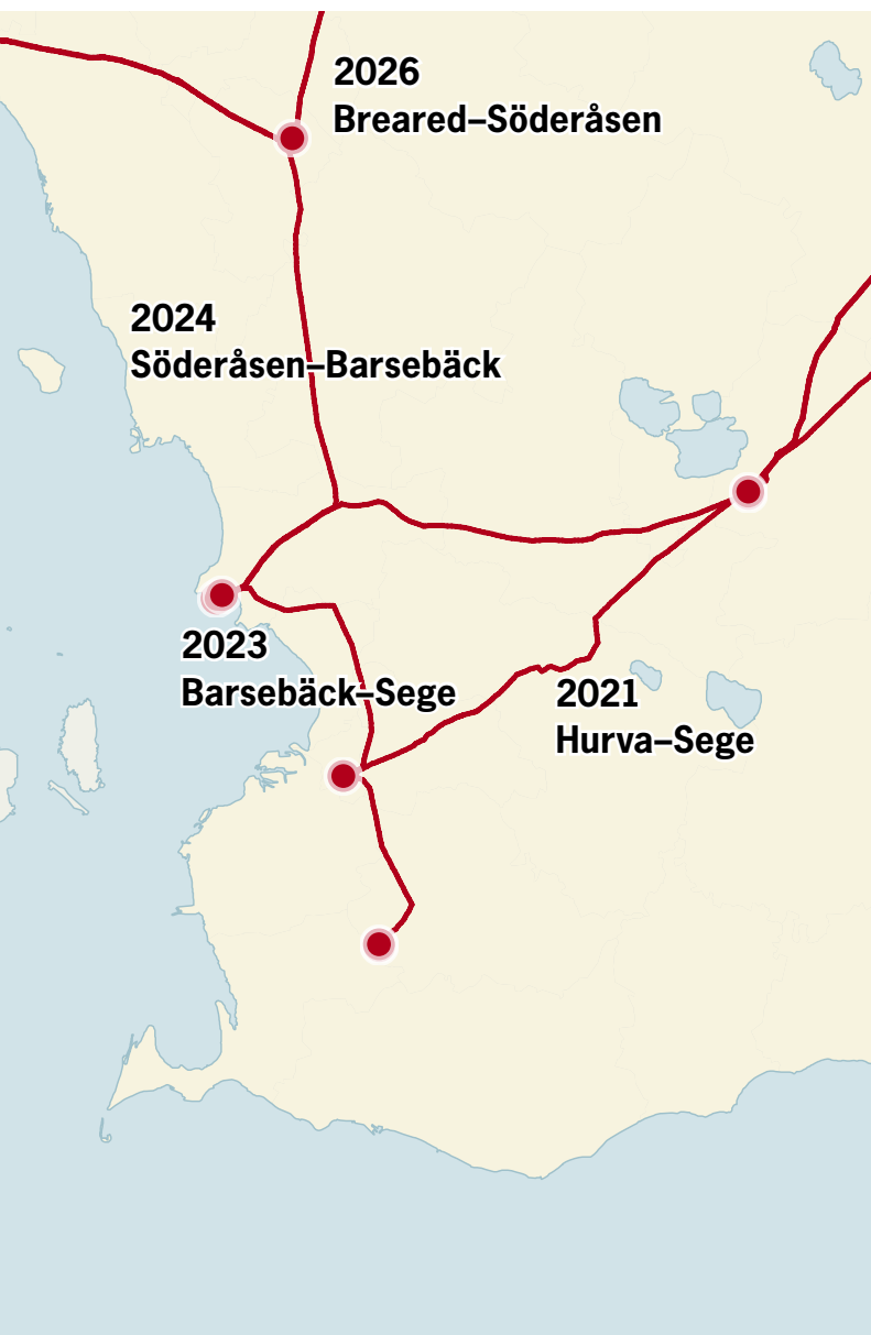
Figur 7: Ledningsförnyelser och nätförstärkningar i det skånska stamnätet. | Källa: Svenska kraftnät
